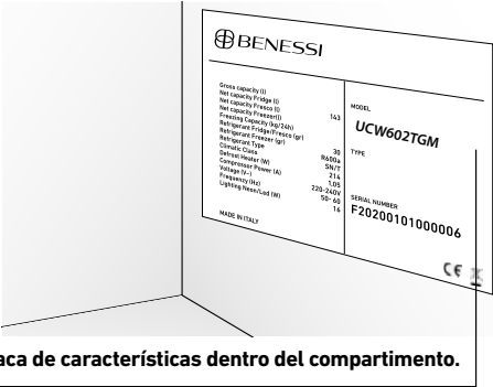
La placa de identificación se encuentra en el interior del equipo, en la esquina inferior izquierda.
